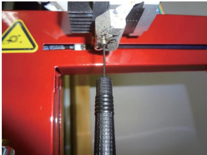
14. (ノズル温度を 210°C以上に保って) 六角レンチでノズルを付けます。
