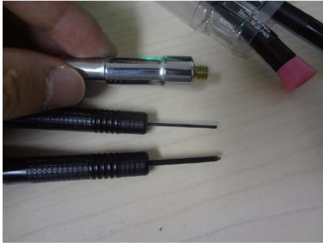
13. (ノズルの高温を保って) 火傷をしないように手袋とメガネをしてから、ドライバーを回しながら、ノズルヒーターの「フィラメントの出口」を通し、焦げた素材を削ります。(ゴミを押し出すのが危険ですから、ドライバーを回しながらゴミを【削る】のです)
