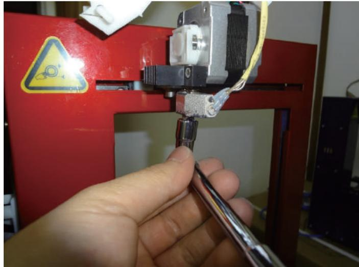
11. ノズルヒーターの「フィラメントの出口」が見えます。ノズルを安全な場所に置きます（火傷に気をつけてください）
