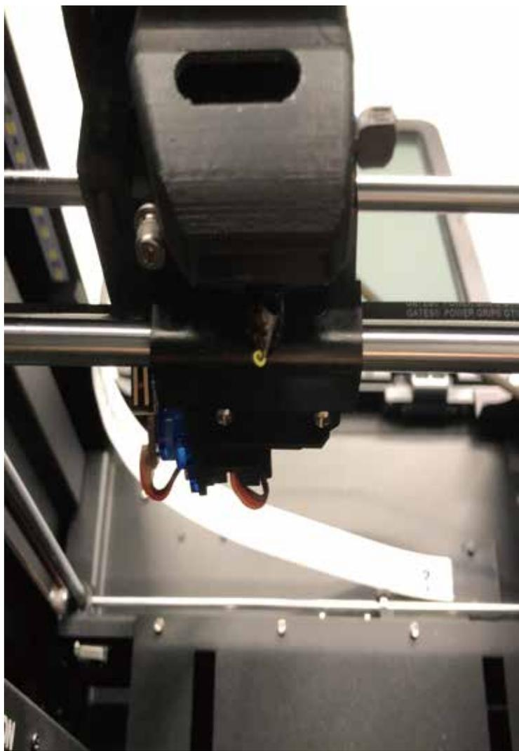
①ヘッドを下から覗き、ヘッドに取り付けられてる六角ネジを3mm六角レンチで外します。
