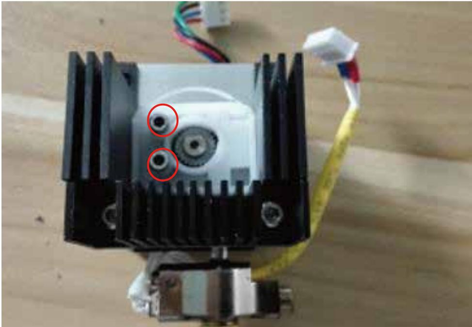
写真の二つのボルトを外し、白い部品の内側にあるローラーについているフィラメントを除去する。
