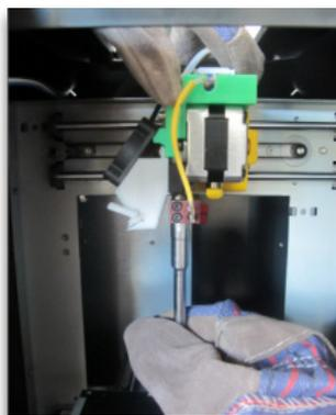
1. Verwenden Sie extrudieren Funktion in der Wartungsfeld, und die Düse wird erwärmt zum Druck.
