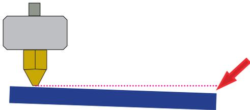
Wie in der linken Seite gezeigt, als Plattform bei der "Düsenhöhe" ist, wird nur ein Teil der Plattform die Düse berühren. Daher müssen wir die Kompensationswerte für alle anderen Kalibrierungspunkte setzen und informieren Sie dem Drucker über den Abstand zwischen Düse und Druckoberfläche per der XY-Ebene
