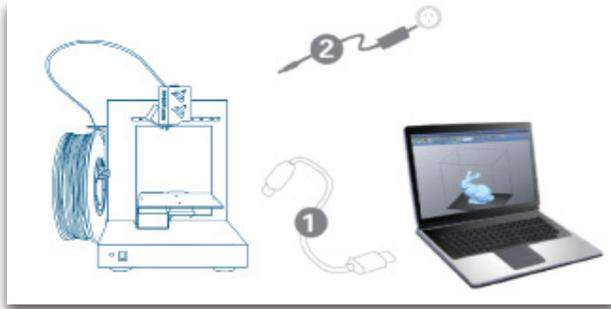
Stellen Sie zunächst sicher, dass Drucker über USB-Kabel an den Computer angeschlossen ist und der Drucker eingeschaltet ist. Die Initialisierung Taste sollte in roter Farbe leuchten.
