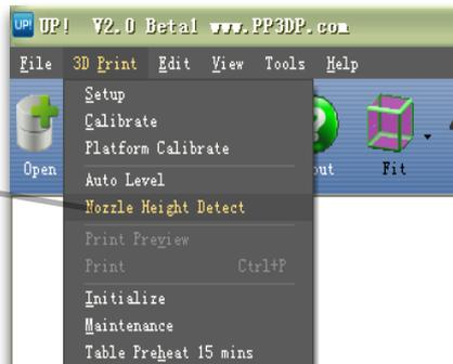
Die gemessene Düsenhöhe wird in einem Pop-up Fenster angezeigt. Dieser Wert wird in Drucker abgespeichert, bis weitere Modifikation gespeichert werden.
