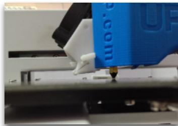
Ein Stück Papier kann verwendet werden, um den Abstand zwischen Düse und Plattform zu messen. Heben Sie die Plattform auf bis sie fast die Düse berühren (zB. Düsenhöhe).
