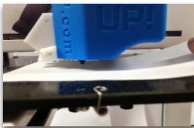
Versuchen Sie, das Papier zu bewegen, und fühlen Sie den Widerstand. Wenn man den Widerstand von der Düse gefühlt hat, bedeutet es, dass der Abstand zwischen der Düse und der Plattform nahe der Dicke des Papiers ist. Stellen Sie sicher, dass Sie das ähnliche Gefühl auf allen 5 Positionen durch Anpassung der Schrauben.
