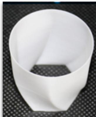
Das Objekt wird ohne Bodenschichten und obere Schichten gedruckt. Nur eine Oberfläche mit Einzelschichtdicke.
