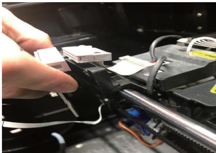
④ヘッドを下から覗いたときに見える2本のネジを外し、水平調整センサーを外します。
