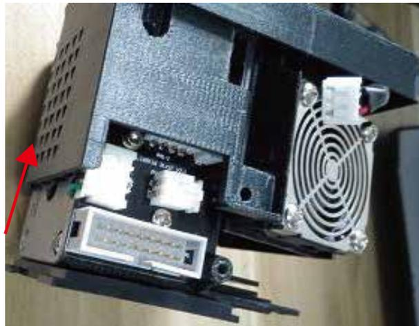
⑦黄色の線のノズルヒーターのコネクタを基板から取り外します。
