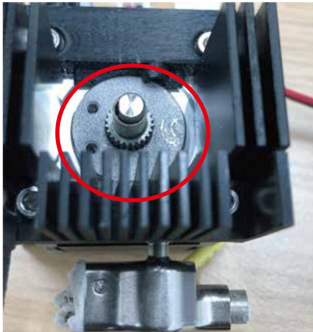
⑦ギア部分のフィラメントの除去が完了したら、ギアカバーやコネクターを取り付け直します。電源を入れ、ソフトウェアで「挿入」をクリックし、ノズルの加熱を行います。
