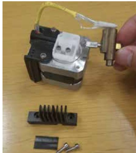
②レンチで基板のネジを外し、ヘッド上部の基板を取り外します。
